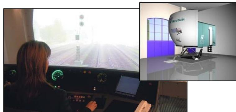
Con i SIDAC la riproduzione del servizio di Condotta è estremamente fedele, compreso suoni e vibrazioni: possono essere simulate **tutte le situazioni operative** (anche di anomalità) e **tutte le condizioni meteo** (es. guasto ripetizione segnali con nebbia).
