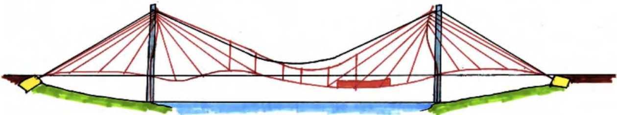
Figura 5-7 Flessione di un ponte ibrido (H.R.S.B.) sottoposto ad un carico ferroviario
