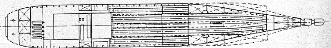
Ponte binari inferiore
