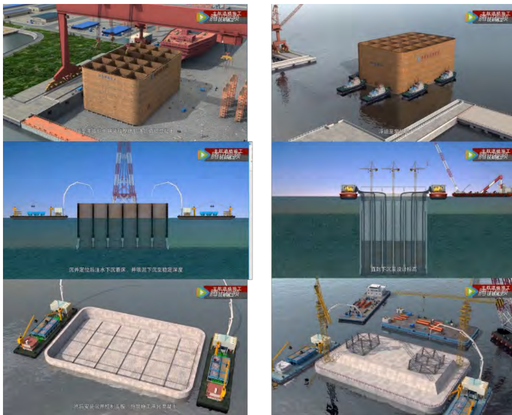
Figura 5-27 Sequenza costruttiva di una fondazione a cassone aperto dell'Hutong Yangtze River Bridge 145
