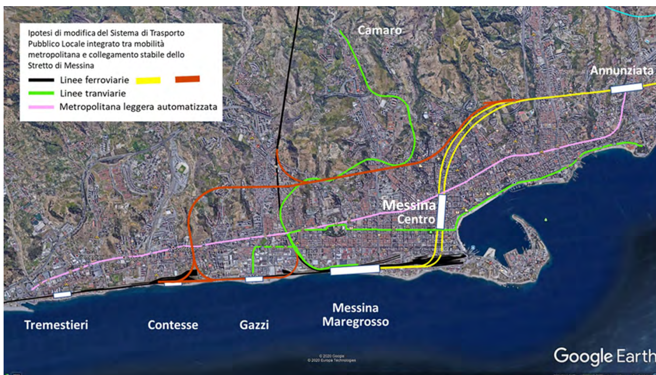
Figura 7-17 Possibili tracciati ferroviari, tranviari e metropolitani da realizzare a Messina (in nero le linee ferroviarie esistenti, in giallo l'ipotesi di nuova linea ferroviaria, in marrone l'ipotesi relativa alla "Gronda merci" da realizzare)
