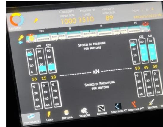
A monitor è possibile vedere la quantità di sforzo prodotta da ogni singolo motore
