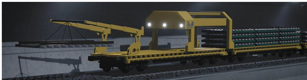
2 - Rimozione ballast a quota di progetto
