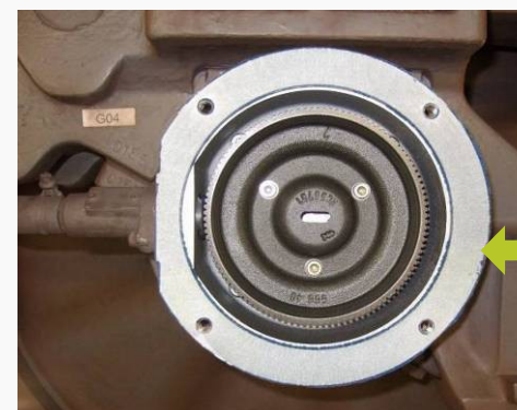
Boccola con sensore integrato FS04
