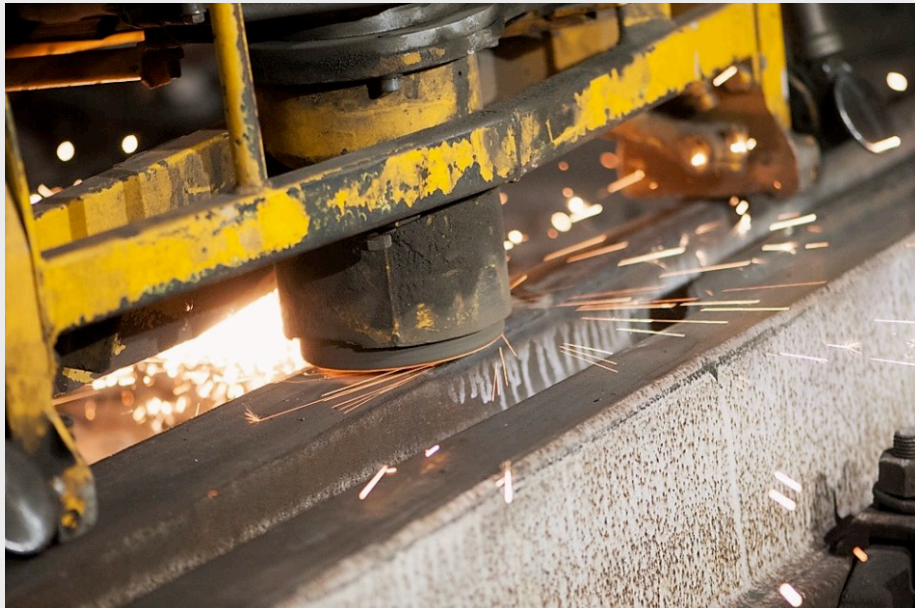
Mola a tazza con telaio durante la sgrossatura
