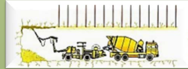
3 PROTEZIONE DEL FRONTE CON GUNITE
