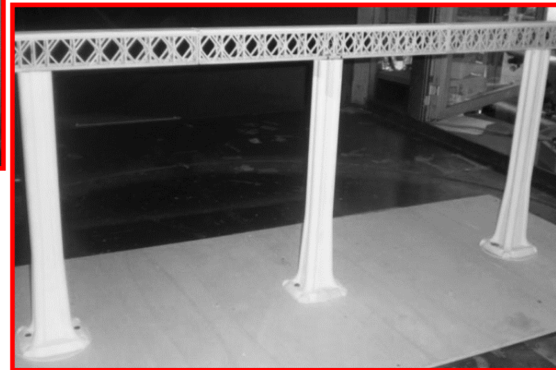
Modello Completo (Impalcato + Pile) [scala 1:200]
