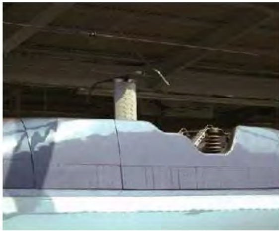
Figura 3 – a) Pantografo telescopico montato su treno AV della Japan Railways West; b) pantografo asimmetrico ottimizzato per limitare l'emissione acustica sviluppato da AD Tranz per DB.
