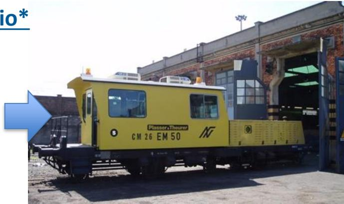
PER L'EFFETTUAZIONE DEI RILIEVI DELLA GEOMETRIA DEL BINARIO FN, A PARTIRE DAL 1988, SI È AVVALSA DEL CARRELLO DIAGNOSTICO EM 50 CHE È STATO REVAMPIZZATO NEL 2000 (HW & SW)\*\*
