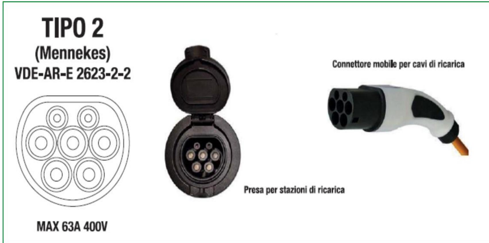
Mono/trifase, 2 contatti pilota, max 32A (63A), 230/400V, si trova sia sui veicoli, sia sulle colonnine.
