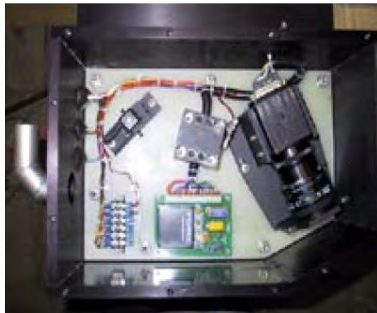
Sistema ottico per il rilievo dell'usura della rotaia
