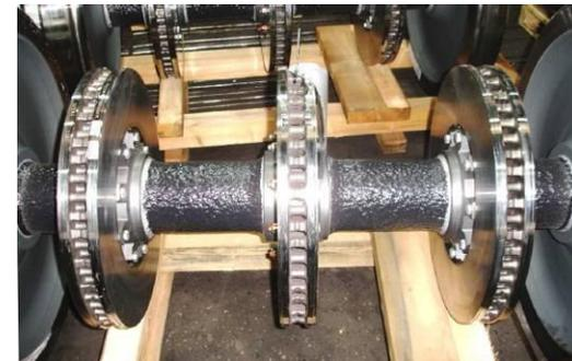
Lucchini RS ha sviluppato e brevettato una strumentazione volta a rilevare e registrare le sollecitazioni scambiate tra veicolo ed infrastruttura, trasmettendo i dati a bordo veicolo in telemetria.
