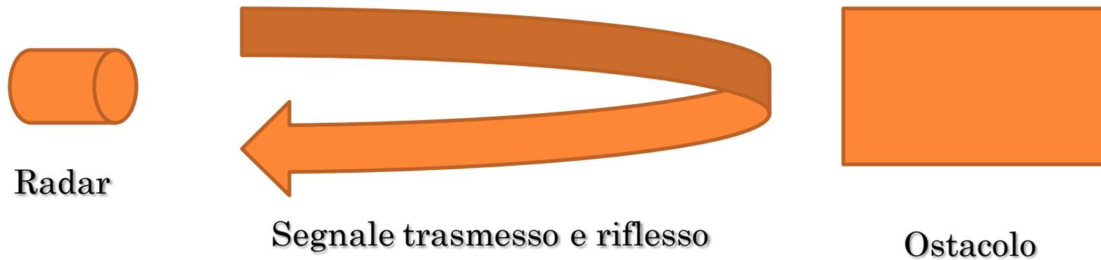
Il radar misura la presenza di un segnale riflesso e la differenza di frequenza (generata dall'effetto Doppler) in tal modo può determinare:
