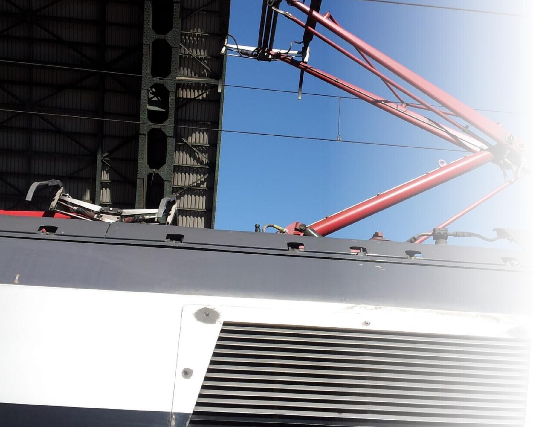
**il pantografo** con i treni in doppia composizione richiede molta flessibilità nella captazione dovuta alla interazione pantografo /catenaria
